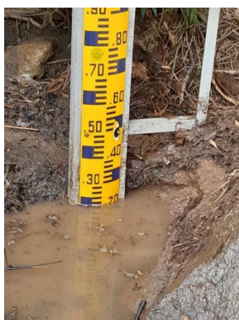
รูปที่ 5.2.1-2 การติดตั้งแผ่นวัดระดับน้ำ (Staff Gauge)
